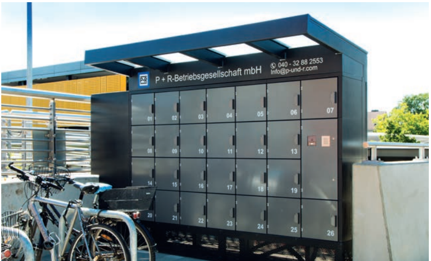
Schließfachanlage SECURE, 26 Schließfächer mit Elektroinstallation plus seitlichem Technikfach, ausgestattet mit einem RFID-Autorisierungssystem sowie dazugehöriger auftragsbezogener Steuerungslösung mit integrierter Fernwartung und Anlagenüberwachung, Überdachung mit VSG Klarglas, Stahlkonstruktion in DB 703 eisenglimmer
