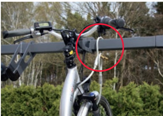
▲ Sicherungsseil zum sicheren Abschießen: durch das Vorderrad durchziehen und die Endschleife mit der Seilanfangschleife mittels bauseitigem Vorhängeschloss sichern
