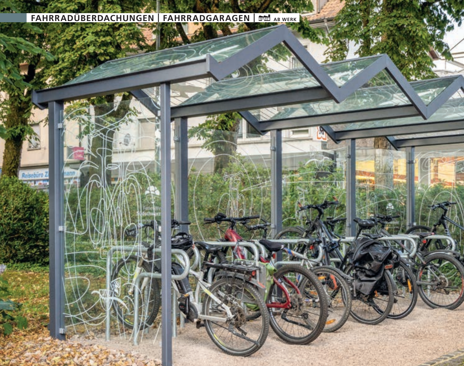
Fahrradüberdachung TANGENTA, Dachbreite x Dachtiefe 6200 mm x 2250 mm, Seiten- / Rückwände ESG, Klarglas, Scheibendekoration bauseits, Fahrradständer SALVADOR, Stahlkonstruktion in RAL 7040 fenstergrau
