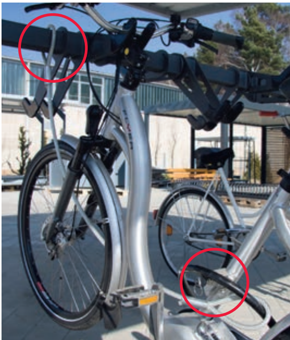
▲ Diebstahlsicheres Abstellen: Sicherungsseil durch das Vorderrad durchziehen und die Endschleife am hinteren Rahmen / Rad mit dem bauseitigen Kabelschloss befestigen
